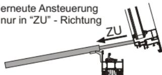
Wird der Antrieb in seiner Endstellung "ZU" von der Versorgungsspannung getrennt (z.B. durch Stop - Stellung bei Spaltlüftung oder Totmannansteuerung), darf eine erneute Ansteuerung nur in "AUF" erfolgen.
