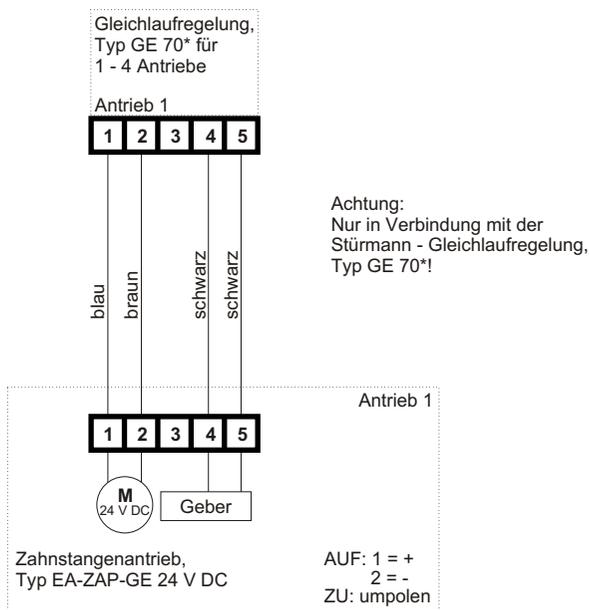
**Achtung: Motorkabel (Klemmen 1 bis 5 = elektronische Lastabschaltung/Geber und Gleichlaufregelung, Typ GE 70\*) unbedingt richtig anschließen. Andernfalls wird der Geber im Antrieb und/oder die Gleichlaufregelung zerstört!**
